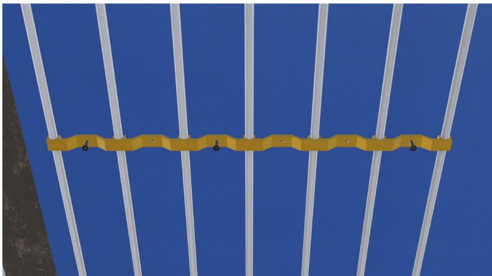
Für das Positionieren des nächsten Registers werden Halteklammern verwendet, sie gewährleisten, dass der 8 cm Rohrabstand beibehalten wird. Ist das nächste Register an den Halteschienen befestigt, werden die Halteklammer wieder entfernt und der Ablauf wird für die nächsten Register wiederholt.
