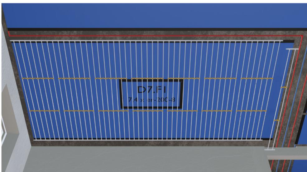
Sind alle für das Feld benötigten Register an den Halteschienen befestigt, werden Nippel und Muffe an den Sammlern zwischen allen Registern miteinander verschweißt, um ein durchgängiges Feld zu erstellen.
