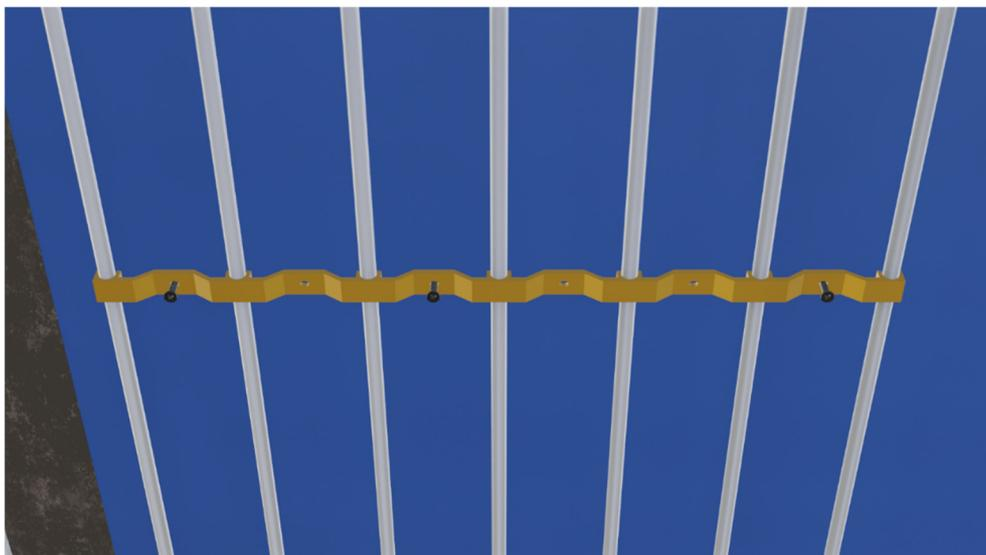
Für das Positionieren des nächsten Registers werden Halteklammern verwendet, sie gewährleisten, dass der 8 cm Rohrabstand beibehalten wird. Ist das nächste Register an den Halteschienen befestigt, werden die Halteklammer wieder entfernt und der Ablauf wird für die nächsten Register wiederholt.
