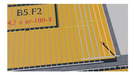
Mit der jetzt ersichtlichen Feldbreite wird das abschließende Register am Sammler und den Halteschienen mit der Rohrschere gekürzt.
